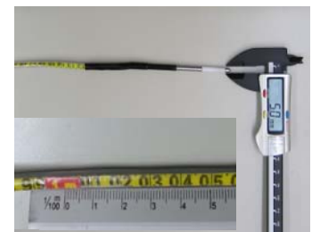
写真3 センサーとメジャーケーブル(φ5mm)
