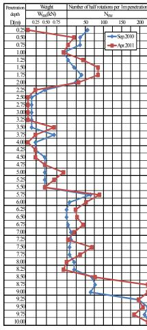
그림7. SWS시험 데이터 (우라야스시 이마가와 지구)
