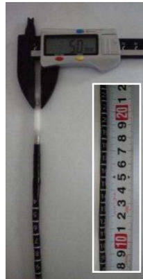
センサー メジャーケーブル 直径5mm×長さ12m (最小目盛 5mm)
