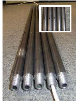
有孔パイプ 長さ1000mm 外径 \phi 19 \pm 0.2 mm、内径 \phi 7 mm 横穴径4mm@250mm(4穴×2=8穴/m)
