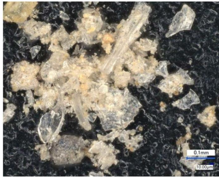
写真1. 団粒(ダマ状)化した里塚の盛土材(火山灰質砂)(顕微鏡 約50倍)
